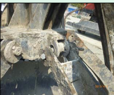
上图为抓铲挖掘机，每片小抓铲插销弯曲变形
